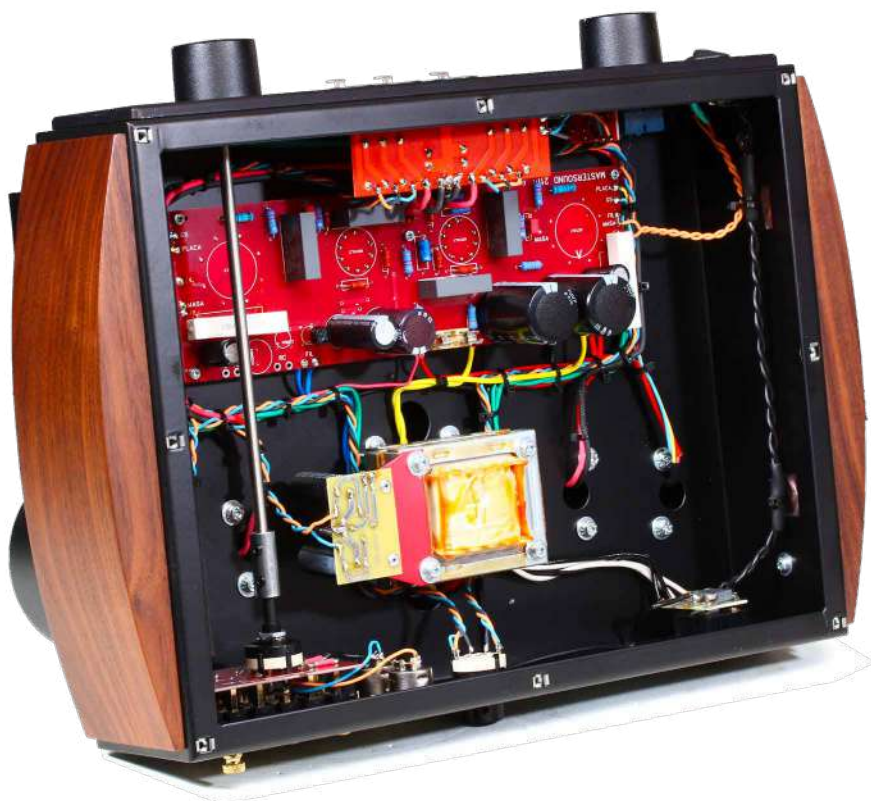
Il segnale di potenza giunge direttamente sul PCB delle connessioni, mentre i resistori del sistema di adattamento di impedenza a tre posizioni vengono portati sul commutatore rotativo posto sul pannello posteriore con tre cavi.
