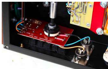
La commutazione dei segnali in ingresso avviene direttamente sul PCB posteriore tramite un selettore azionato da un rinvio meccanico. In un PCB separato è sviluppato il phono MM.
