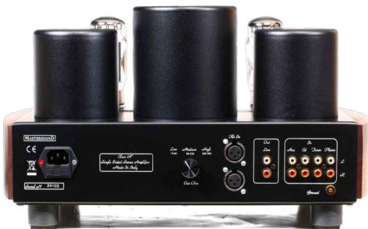
Al centro dell'apparecchio è presente il commutatore delle tre regolazioni di carico, a un'estremità gli ingressi linea con tre RCA e un XLR condiviso con uno di questi, un ingresso phono MM, con la presa di terra molto comoda, e una uscita linea RCA. All'estremo opposto la connessione di alimentazione a 220 con vaschetta IEC.
